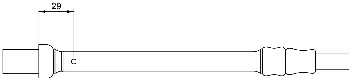
Alle Tonlöcher  $\text{\O}4\text{mm}$ .  $90^\circ$  zum D-Loch wird ein M4-Gewinde für die Stimmschraube gebohrt.
