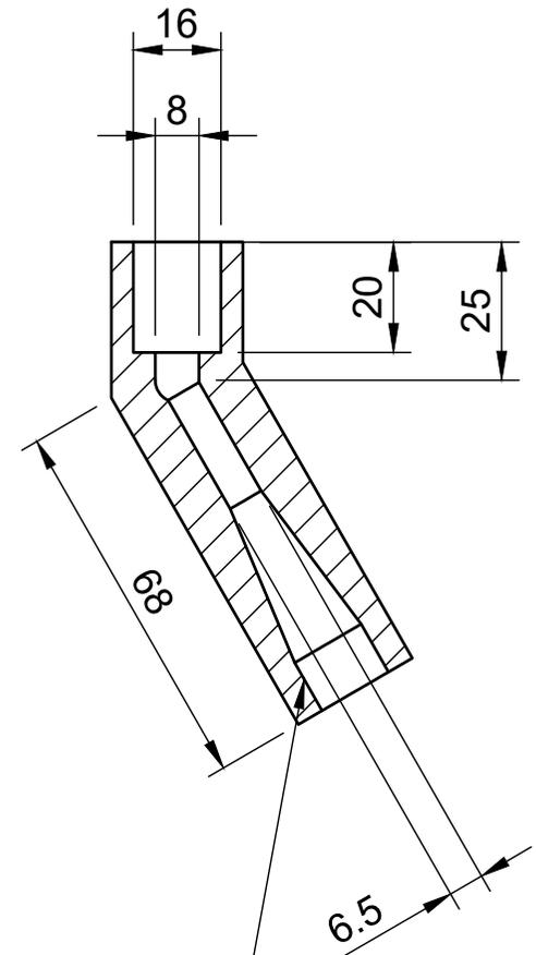
\*Mit Blechschälbohrer auf 12-14mm aufbohren
